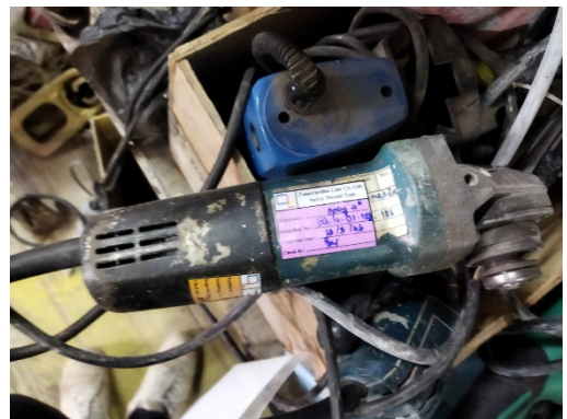
รูปที่ 65 ตรวจสอบอุปกรณ์ไฟฟ้าที่ใช้ในพื้นที่ก่อสร้าง เดือนละ 1 ครั้ง
